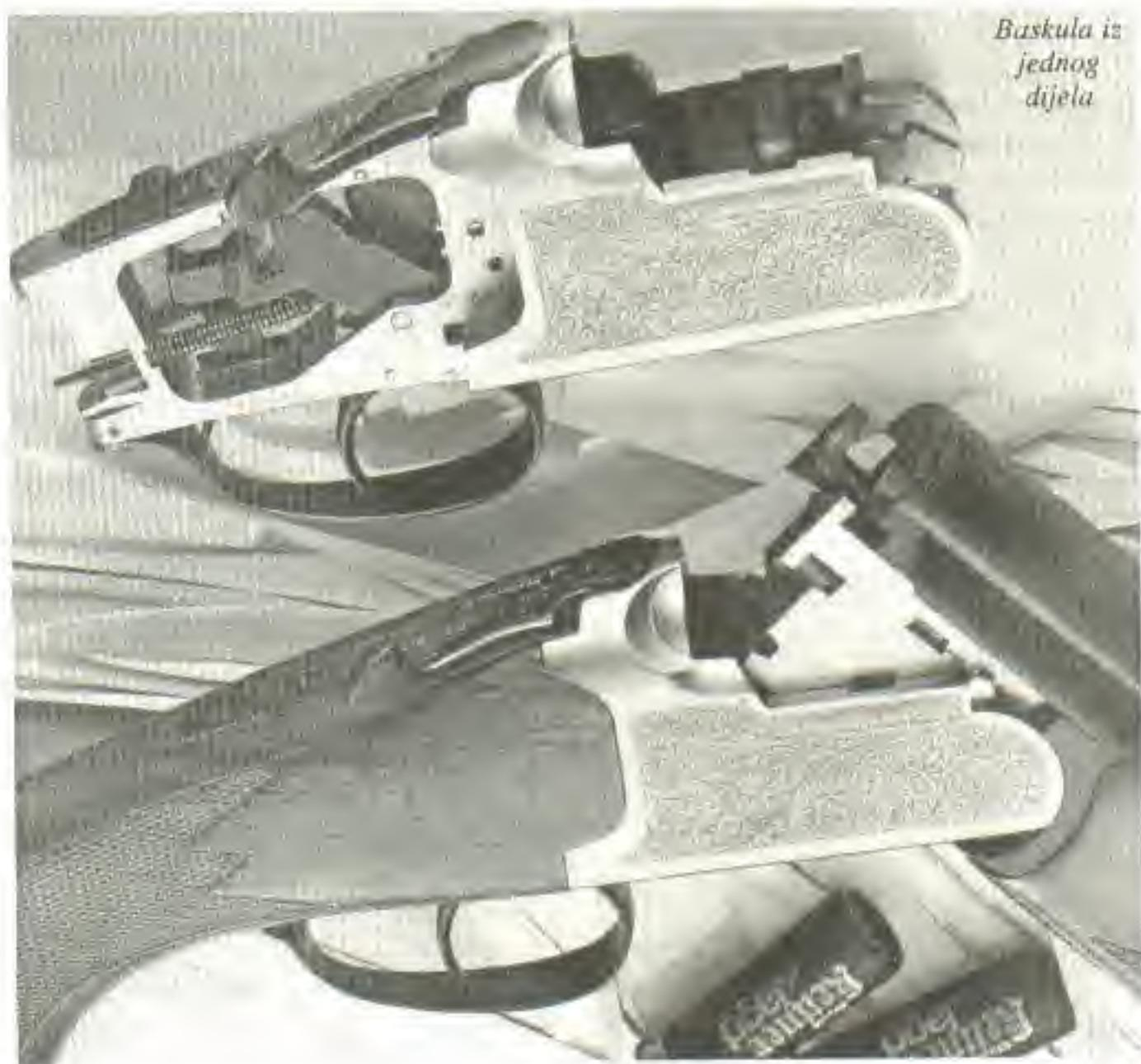
Udarni mehanizam je modifikacija Anson - Deeley sistema sa spiralnim udarnim oprugama iza udarača i sa visećim zapinjačama.
